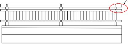
高欄?変形・欠損 L=350mm 写真番号:48
