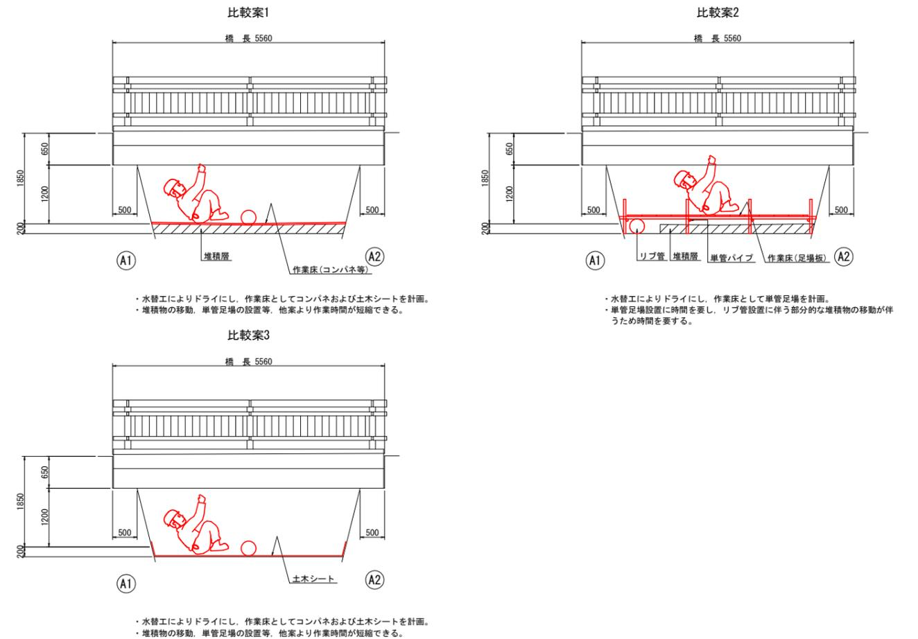
・水替工によりドライにし、作業床としてコンパネおよび土シートを計画。
